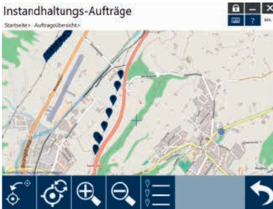
Bild 5 Auf einer Karte zeigt das System an, welche Verteilanlagen (Tragwerke) sich in der Nähe des aktuellen Standorts befinden.
